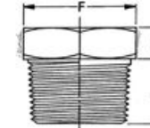
tappi testa esagonale hex head plug To ANSI B 16.11 - BS 3799
